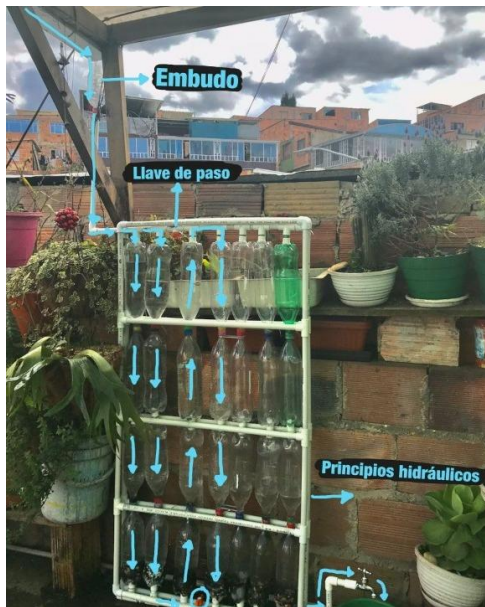
Figura 1. Prototipo de sistema de captación y filtración de agua lluvia instalado
