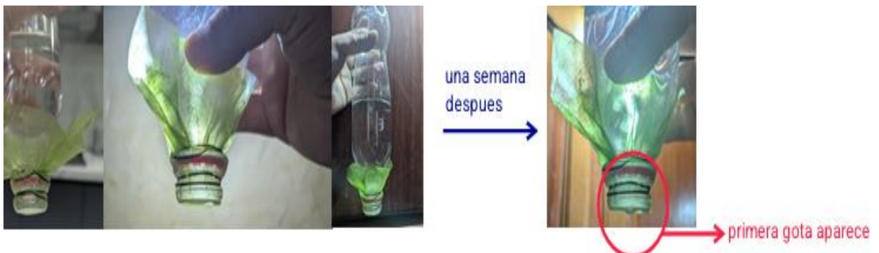
FIGURA 17. Prueba físico mecánica de permeabilidad.
