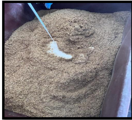
Figura 12 Hidratación de la cascarilla con pegante para madera y agua
