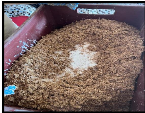
Figura 13 Cascarilla hidratada, cambio de tonalidad
