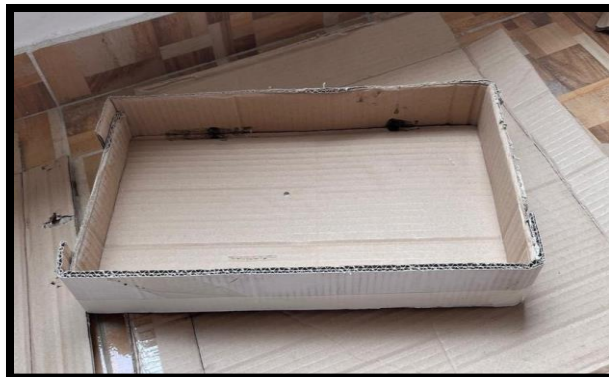
Figura 5 Armado y pegado de molde
