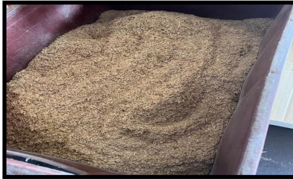
Figura 10 Mezcla de la cascarilla tras pasar por la licuadora
