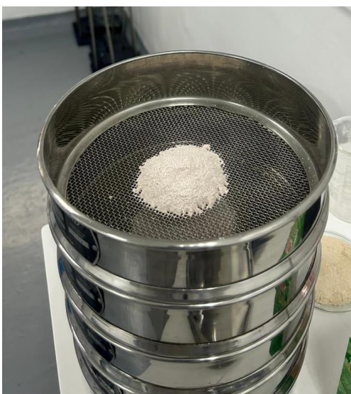
Ilustración 11. Montaje del proceso de tamizaje de la cáscara de huevo. Tomado de (Elaboración propia., 2024)
