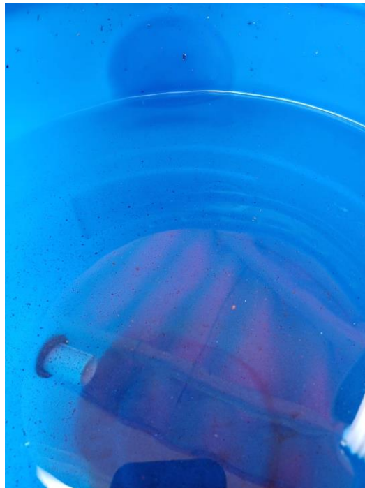
Figura 4. Solidos sedimentados en el fondo del tanque de almacenamiento
