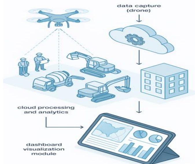
Ilustración 5 Prototipo conceptual Sistema dron e interfaz digital (Elaboración propia, 2025)
