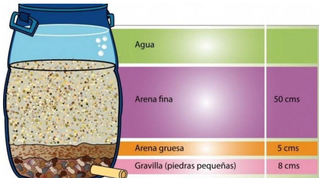
Ilustración 12 Filtros lentos de arena.
