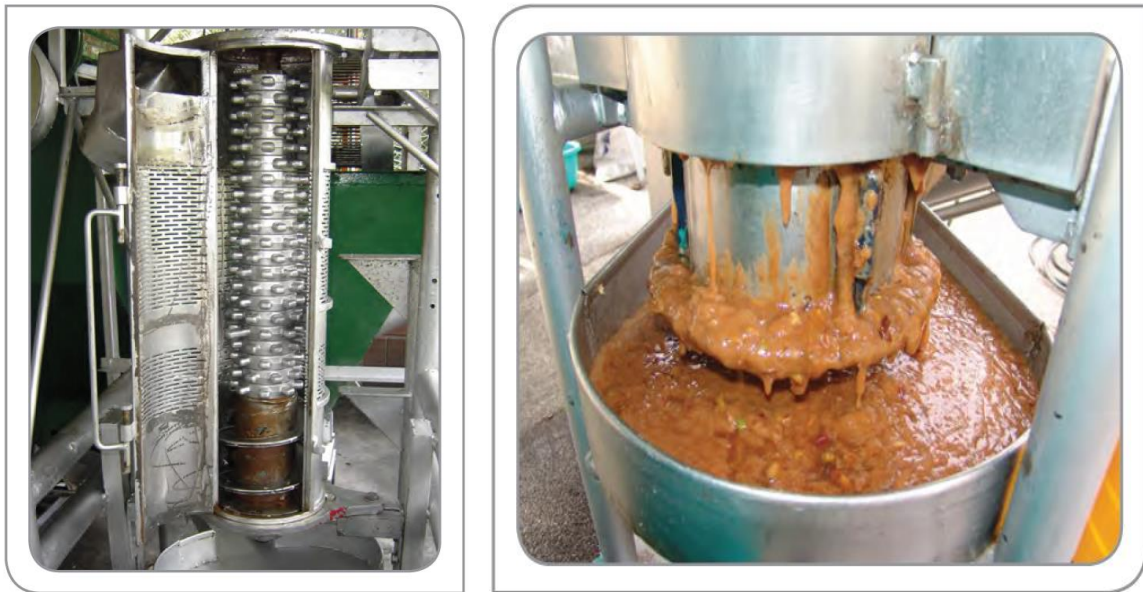
Figura 3. Desmucilagador mecánico Deslim.
