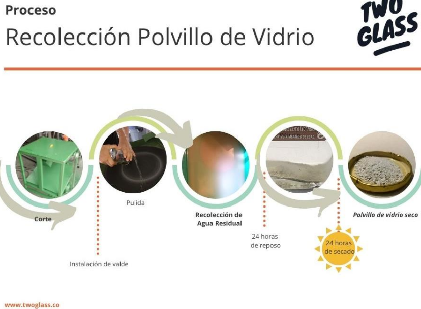
Figura 10 Proceso de separación de partículas de vidrio del agua residual en el proceso de corte y pulido de la empresa TwoGlass
