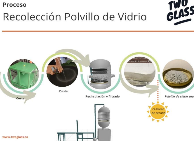
Figura 11 Proyección Proceso de separación de partículas de vidrio del agua residual en el proceso de corte y pulido de la empresa TwoGlass
