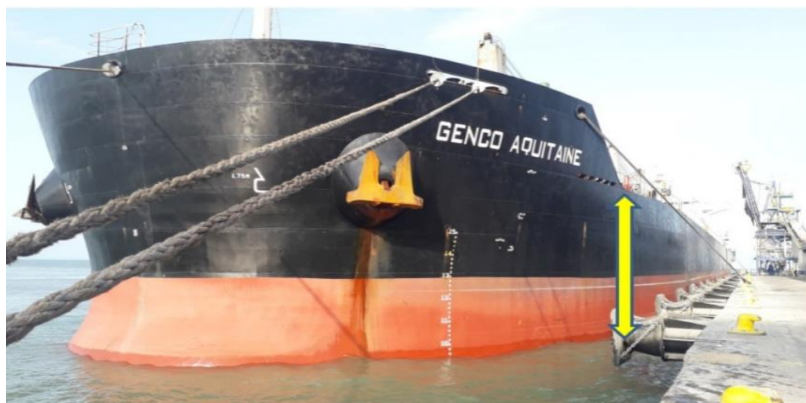
Figura 25 Francobordo de una embarcación y las defensas en el muelle Compas Tolú
