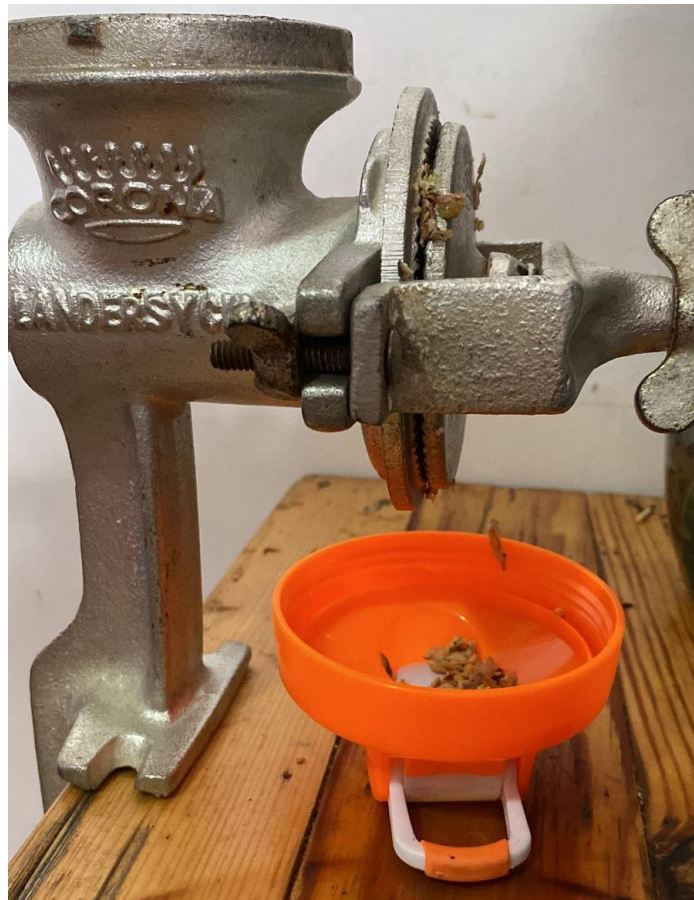
Ilustración 4. Molino manual implementado para triturar 30 semillas de Neem.
