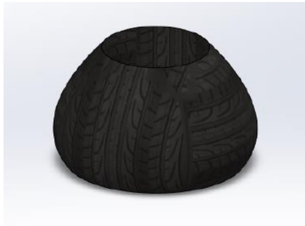
Ilustración 19. Diseño 3D del prototipo de la goma como soporte final del bastón canadiense. Nota Elaboración propia (2025).
