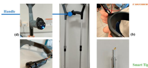
Ilustración 2 Arcobelli, VA et. al(2023)2Conjunto de mCrutch: ( a ) prototipo final de mCrutch; ( b ) ubicación de la batería; ( c ) estructura mecánica modificada de la punta que incorpora la celda de carga miniaturizada; ( d ) estuche protector de plástico que contiene la electrónica; y ( e ) [Ilustración] recuperado https://doi.org/10.3390/s23084151
