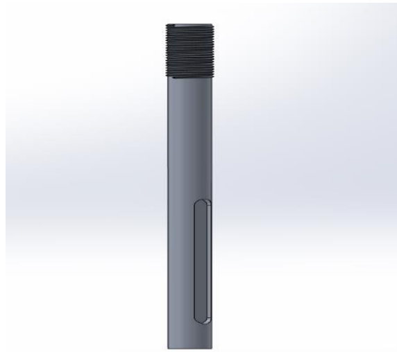
Ilustración 18. Diseño 3D del prototipo del tercer bastón de soporte de estabilización de peso, graduación de altura con rosca del bastón canadiense. Nota Elaboración propia (2025).
