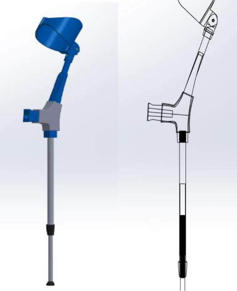
Ilustración 21. Diagrama de grado, diseño 3D del prototipo bastón canadiense. Nota Elaboración propia (2025).
