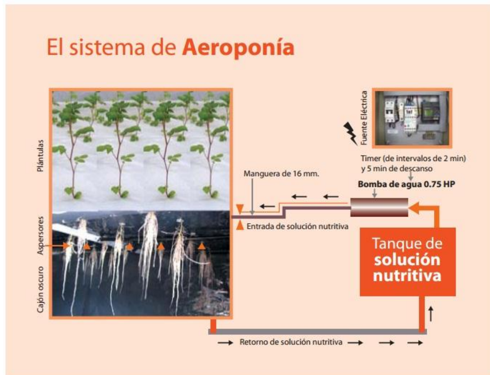
Figura 1.2 Esquema Sistema Aeropónico
