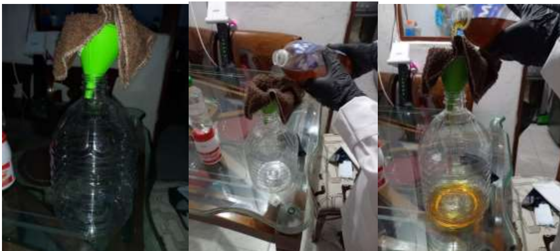
Imagen 2. Proceso de filtrado del aceite vegetal usado.
