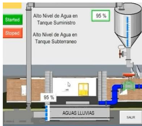
Ilustración 23 - Elaboración propia. Alto nivel de agua en tanque subterráneo – alto nivel de agua en tanque abastecedor
