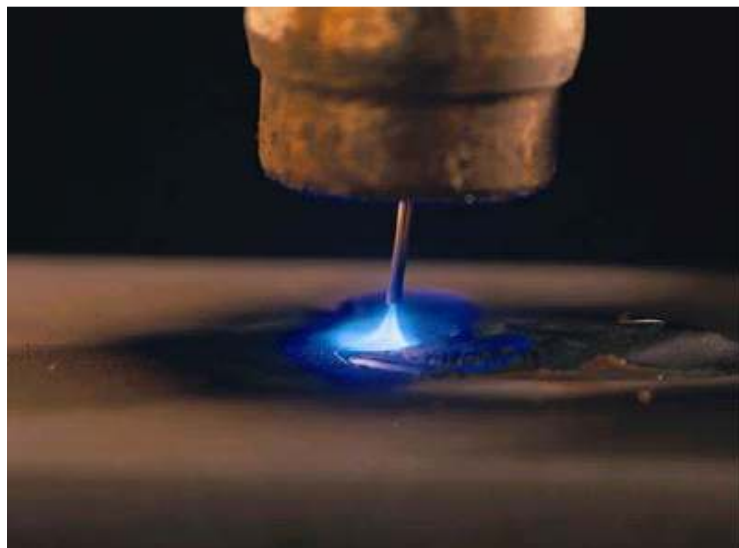
Figura No. 17. Transferencia por tensión superficial TTS, Lincoln Electric, (2011). p. 2
