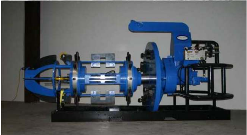
Figura No. 51. Ilustración de la máquina automática para biselar vista lateral. LINCOLN ELECTRIC, Presentación, (2011). p. 14
