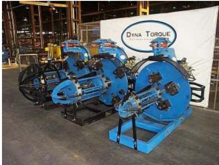
Figura No. 49. Máquina para biselado automático de tubería (PFM). LINCOLN ELECTRIC, Presentación, (2011). p. 12
