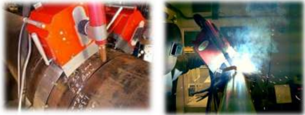
Figura No. 47. Ilustración del sistema orbital de soldadura de cabezal sencillo. LINCOLN ELECTRIC, Presentación, (2011). p. 9
