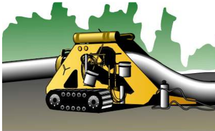
Figura No. 42. Máquina para doblar la tubería. IPL TECHNOLOGY, pdf, (1995). p. 38
