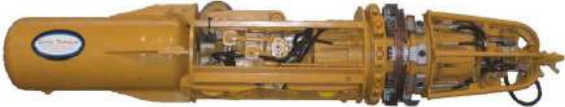
Figura No. 52. Dispositivo para la alineación de la tubería. LINCOLN ELECTRIC, Presentación, (2011). p. 17
