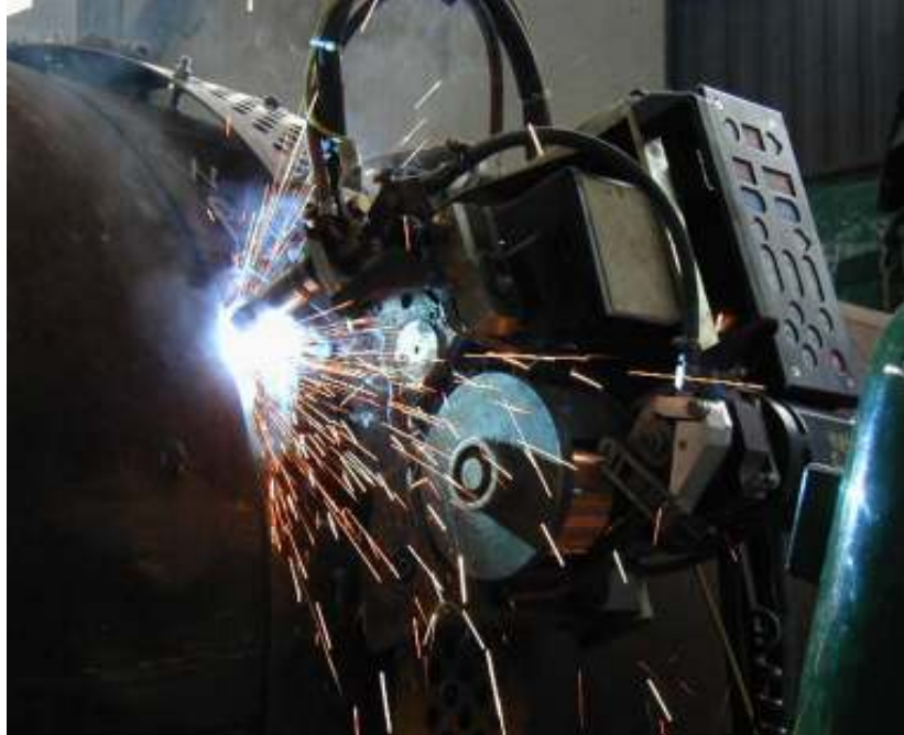
Figura No. 32. Máquina orbital sencilla, SICIM Colombia, presentación OBC, (2011). p. 7
