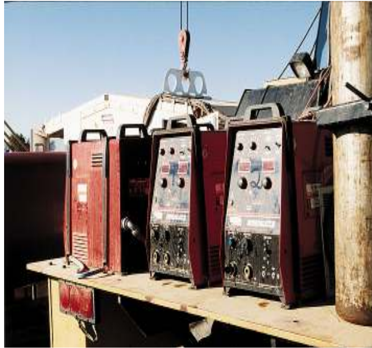
Figura No. 23. Fuentes de poder para el proceso de soldadura STT, Lincoln Electric, (2011). p. 15
