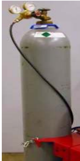
Figura No. 9. Cilindro típico de gas usado en los procesos de soldadura. Lincoln Soldaduras de Colombia, presentación (2007). p. 9
