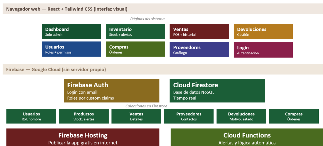
Figura 2. Diagrama de arquitectura del sistema
