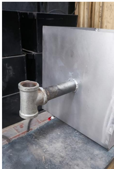
Figura 6. Ilustración de la tubería adaptada para la salida de gases.
