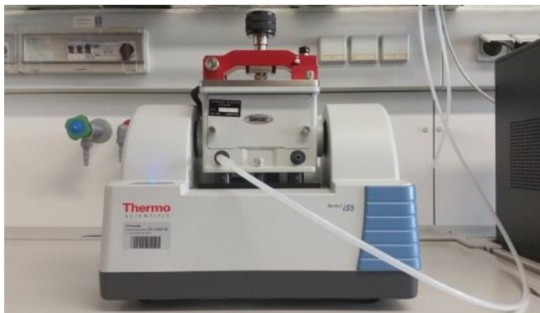
Figura 3. Espectrómetro infrarrojo con transformada de Fourier. (Thermo Fischer Scientific, s.f)
