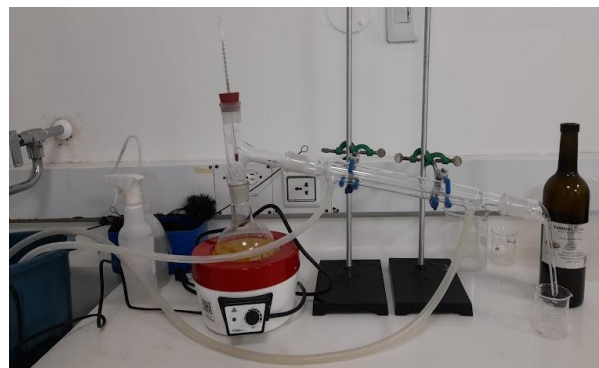
Montaje destilación simple. Autoría propia.
