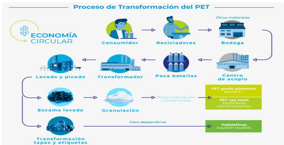
Figura 4. Proceso de Transformación del PET
