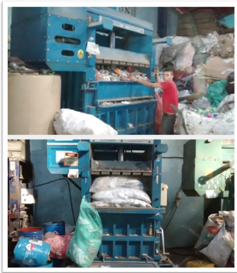
Figura 10. Prensado de PET y Bolsas (PE-BD)
