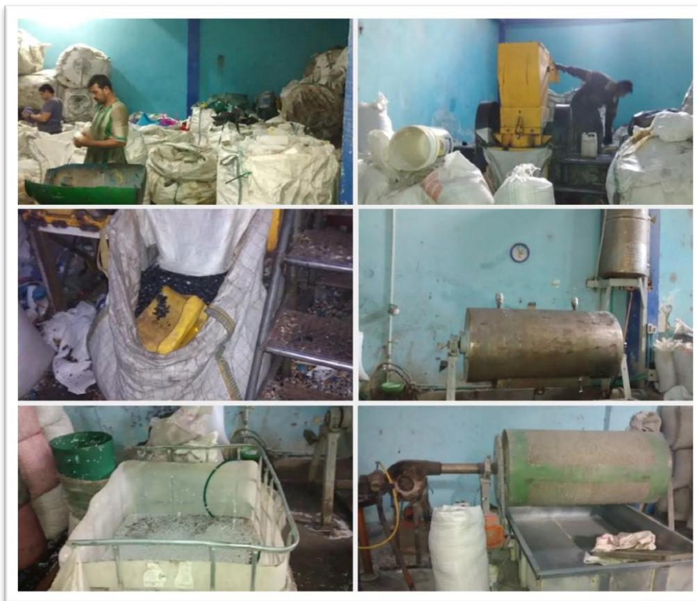
Figura 9. Procesos, de clasificación, molido, lavado, y secado de plástico
