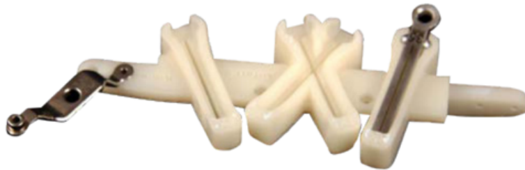
Figura 11. Guía de cirugía impresa por 3D Systems para cortar el peroné que se usó en la reconstrucción de la mandíbula de Blessing Makwera
