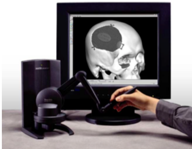
Figura 2. Diseño de placa a partir de modelo tridimensional del cráneo
