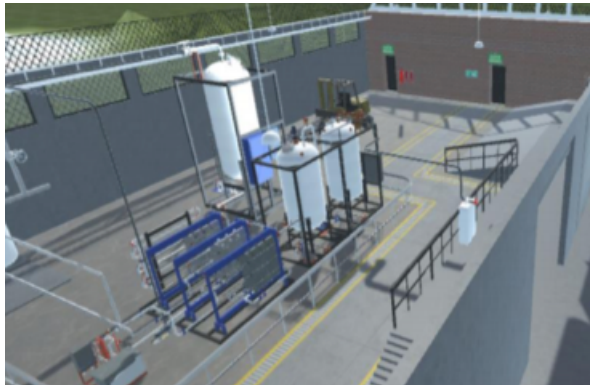
Figura 1. Planta 3D. Pasteurizadora de leche
